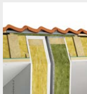
Abb. 6: Wandelementstoß – Vertikalfuge (Detaildarstellung)
