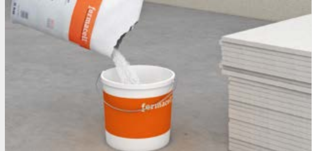
Einstreuen fermacell™ Fugenspachtel in sauberes Wasser, danach einsumpfen lassen
