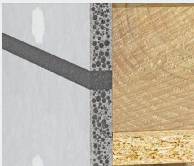
Bild 4: Verschließen der Fuge mit einem vorkomprimierten Dichtungsband (Detail)
