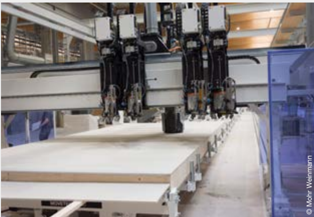
B&O Bau GmbH - Zuschnitt (Türöffnung)
