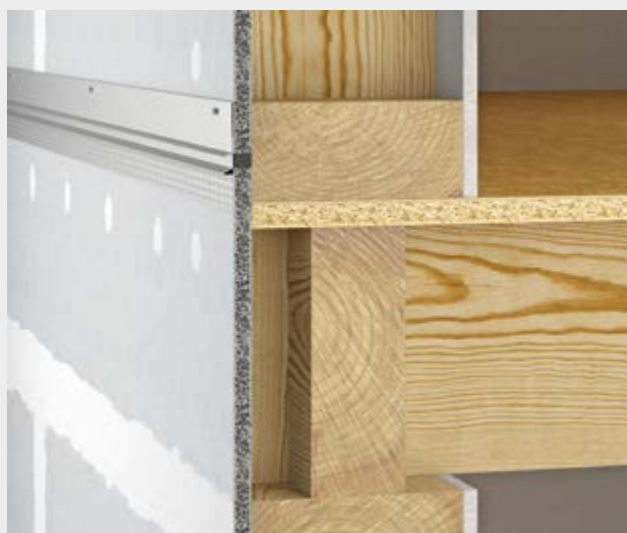
Bild 6: Fertig montierter Plattenstreifen mit fermacell™ Deckenstoßprofil
