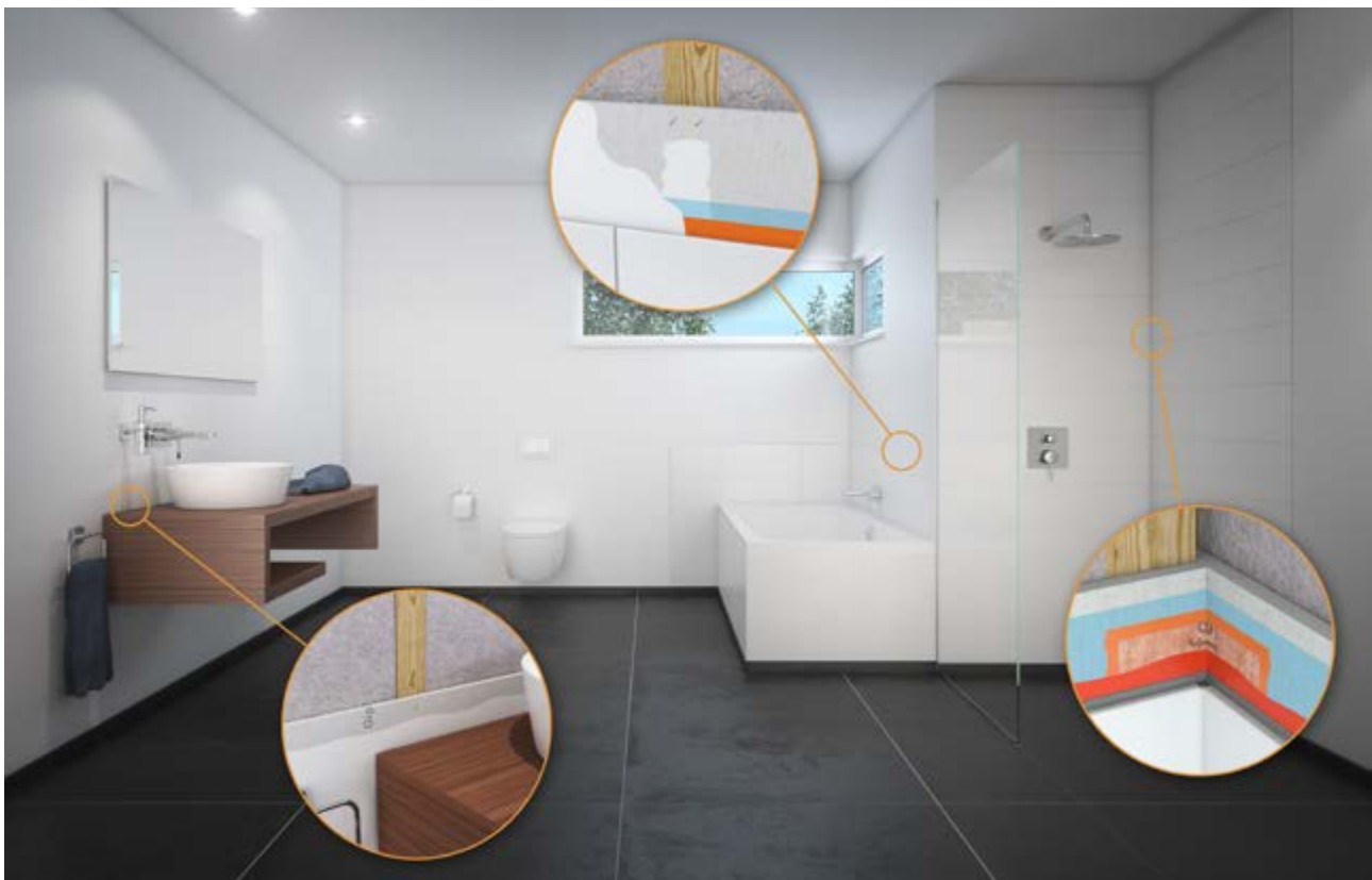
1 HT 11-320 fermacell™ Holzständerwand im häuslichen Badbereich
