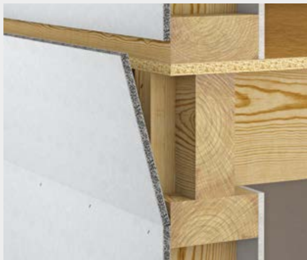
Bild 2: Montage des Plattenstreifens
