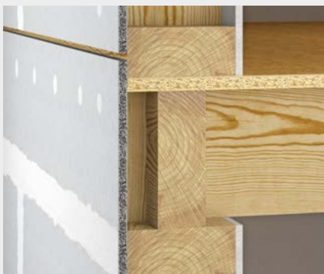
Bild 3: Mit HD-Fugentechnik versehener Bereich des Plattenstreifens
