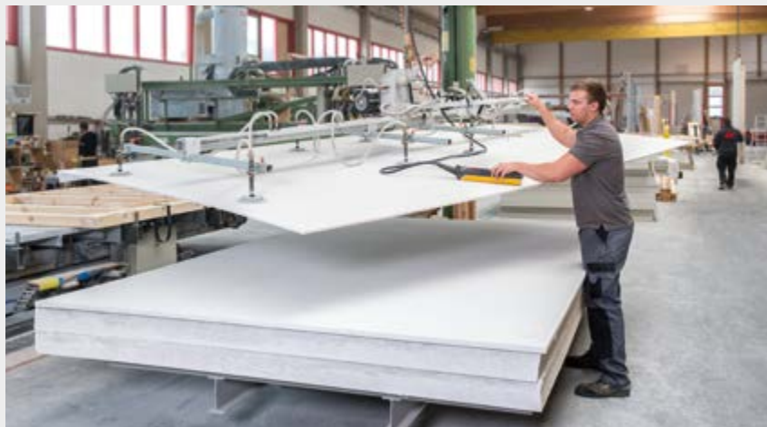
Transport von fermacell® Gipsfaserplatten mit einem Vakuum-Hebegerät
