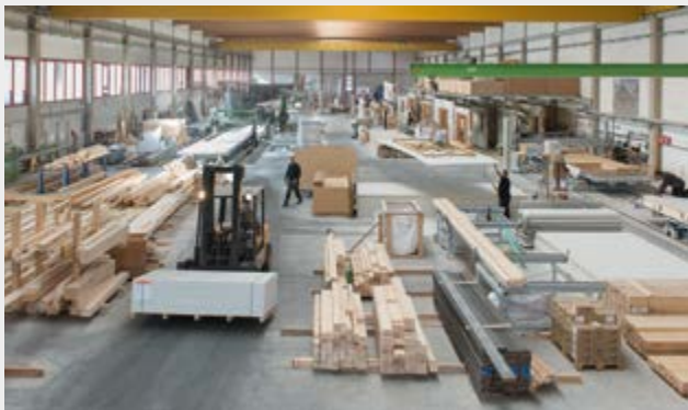
Fertigung von Holzbauelementen mit fermacell® Gipsfaserplatten
