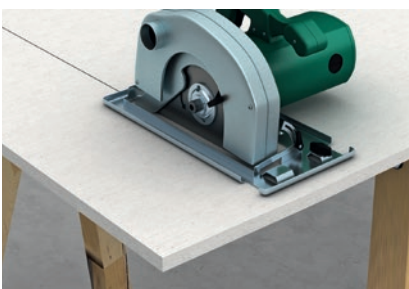
Sägen mit Handkreissäge (Drehzahl regulierbar)
